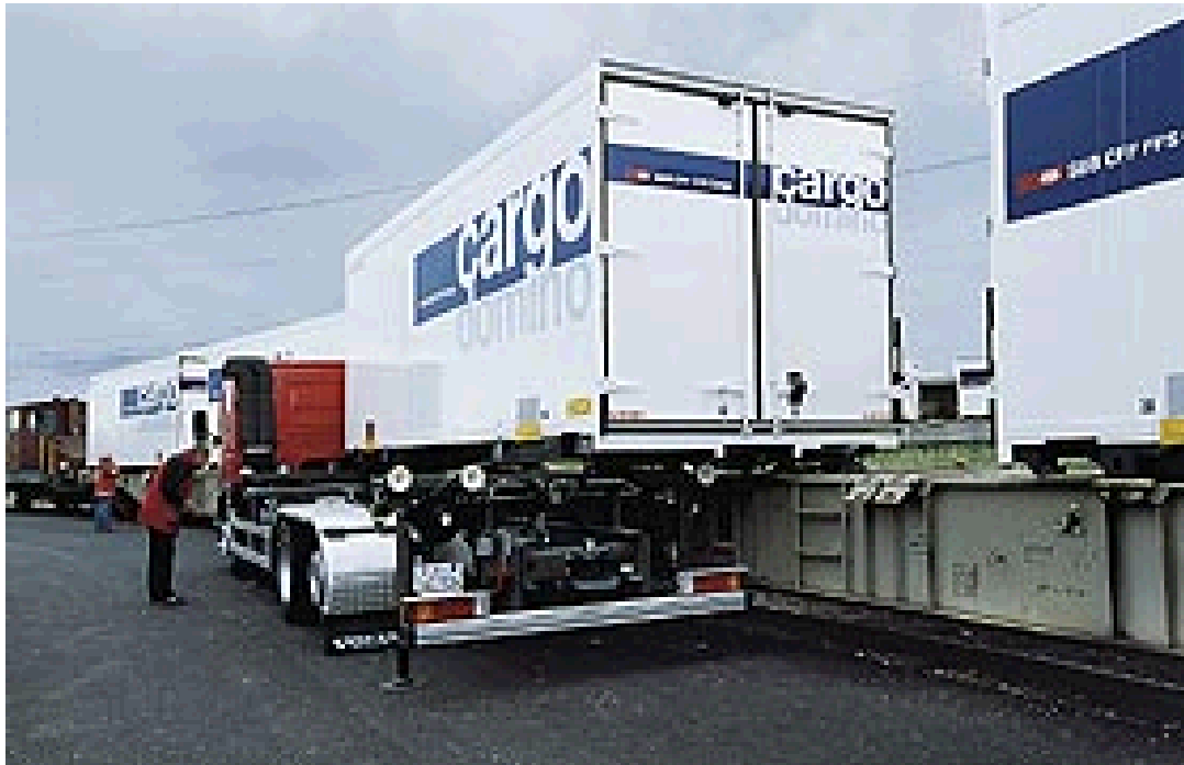
Figur 3.1 Eksempel fra Sveits på nyutviklet automatisert horisontal overføringsteknikk av lastbærer mellom lastebil og tog. Omlastingen tar omlag fem minutter iflg. SBB CFF FFS Cargo
